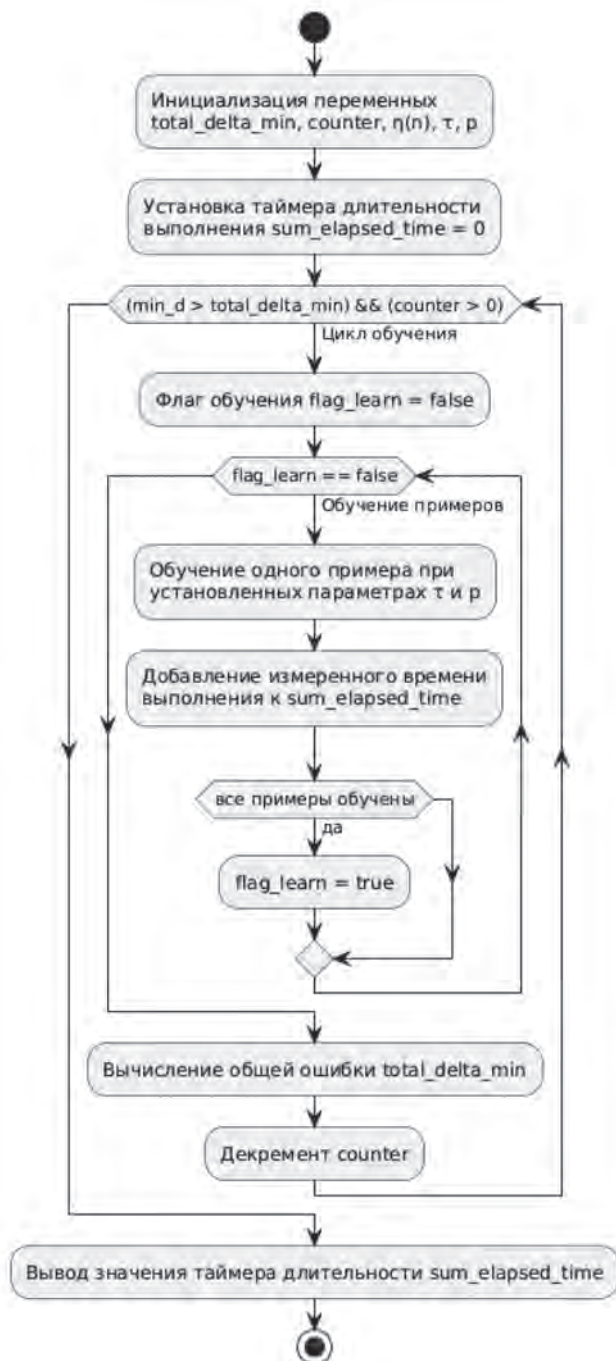
Рисунок 1. Алгоритм расчета времени процесса обучения НС в зависимости от параметров \tau и \rho
