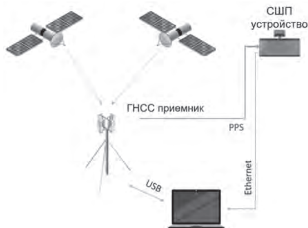
Рисунок 1. Схема экспериментальной установки для синхронизации временных шкал ГНСС-приемника и СШП-устройства
